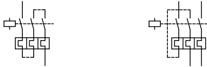
Abbildung 4: Verdrahtung des Motorschutzschalters für den Schutz von Wechselstrom- oder Gleichstrommotoren (Reihenschaltung der Bimetallauslöser)
